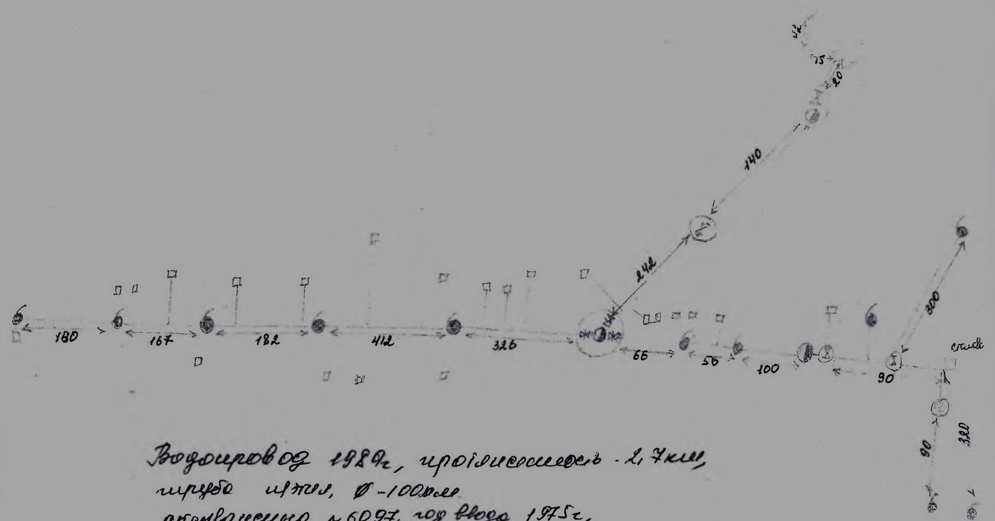
Водопровод 1989г., протяженность - 2,7 км,
